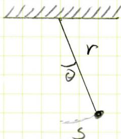
THE MOTION & RESTORING FORCE ARE ALONG THE ARC,  $s$
